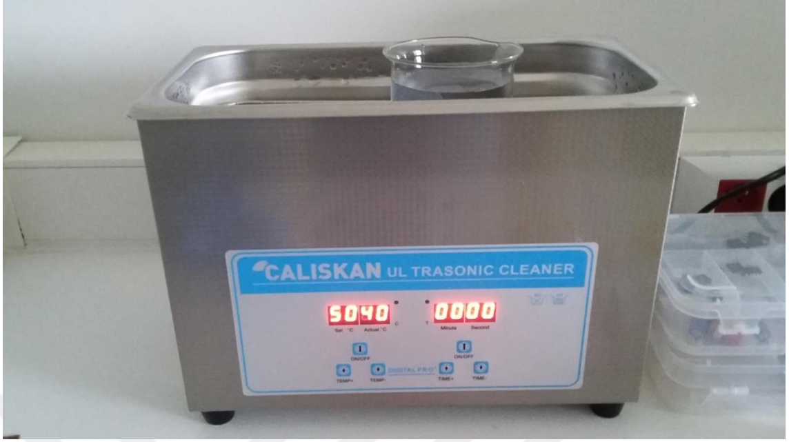
Şekil 3.4. Ultrasonik Temizleme Cihazının Görünümü
