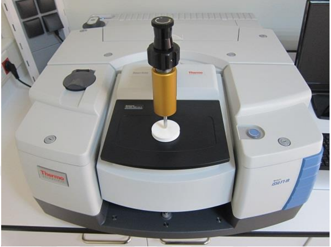
Şekil 3.9. FTIR Spektrometresinin Görünümü (Anonim g,2019)
