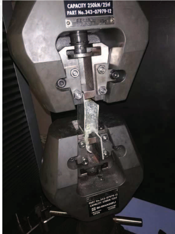
Şekil 4.3. Örnek Çekme testi yapılma anı.
