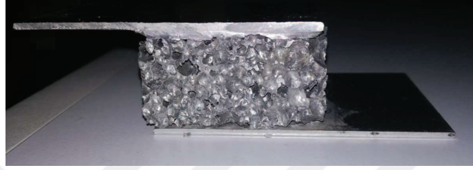
Şekil 3.14. Akfix ile yapıştırılan Sandviç yapı örneği
