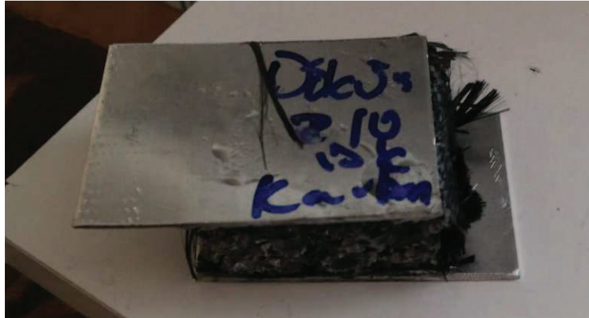
Şekil 3.18. 105 ve 210 dakika aralığında kürlenmeye bırakılmış karbon elyaf takviyeli sandviç yapı
