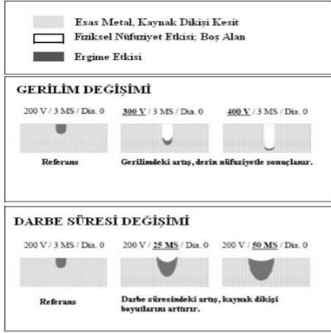
Şekil 2.21. Gerilim ve darbe süresindeki değişimin ergime ve nüfuziyet üzerindeki etkileri. (Çelen S., 2006)
