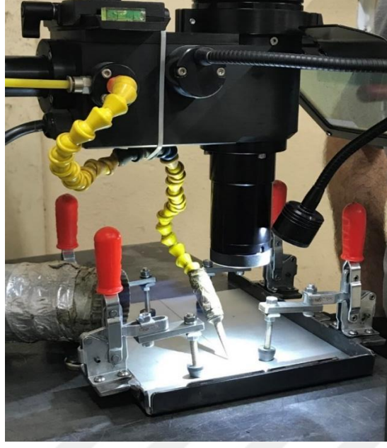
Şekil 3.4. Lazer kaynak makinasında numunelerinin hazırlanması
