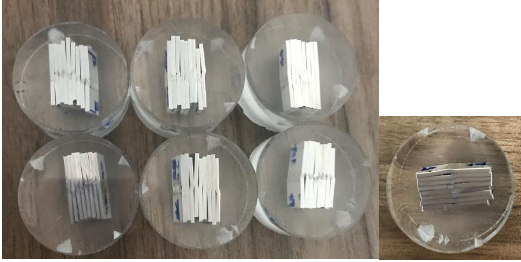
Şekil 3.8. Sertlik ölçümü ve iç yapı incelemek için bakalite alınmış numuneler
