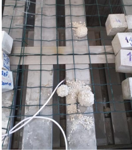
Şekil 4.11. 100 çevrim sonunda dağılan %30 mermer çamuru içeriğine sahip örnekler
