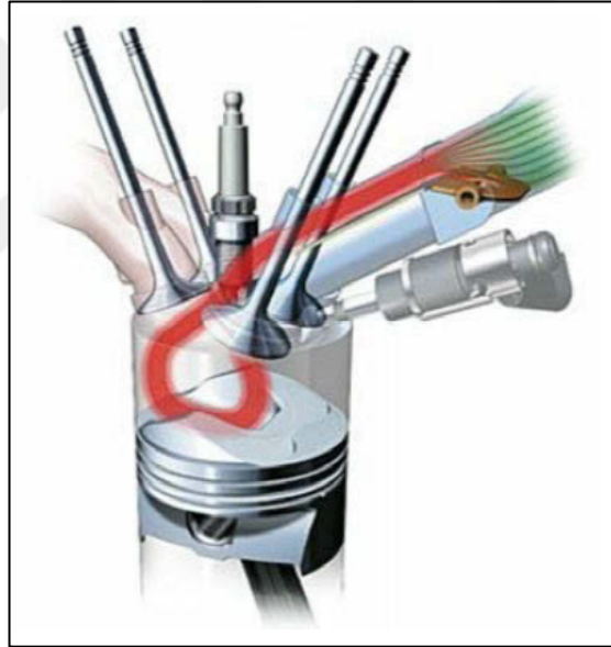
Şekil 2.13. Audi 2.0 FSI motorunun hava yönlendirme sistemi (Basshuysen 2009’den alınmıştır)
