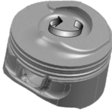
Şekil 2.4. Girdap/Swirl hareketinin oluşmasını destekleyen özel bir piston tasarımı (Basshuysen 2009'dan alınmıştır)
