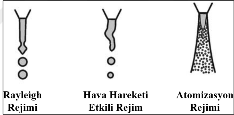
Şekil 3.7. Parçalanma rejimlerinin şematik gösterimi (Baumgarten 2006'dan değiştirilerek alınmıştır)
