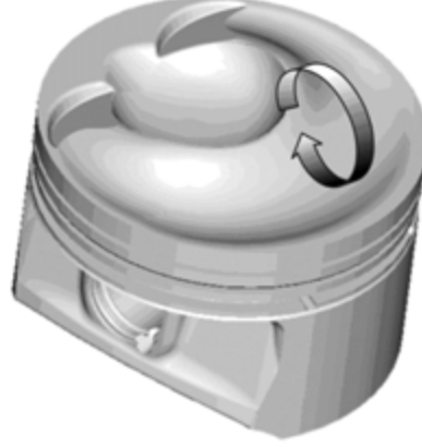
Şekil 2.7. Takla/Tumble tip silindir içi hava hareketini destekleyen piston tasarımı (Basshuysen 2009’den alınmıştır)
