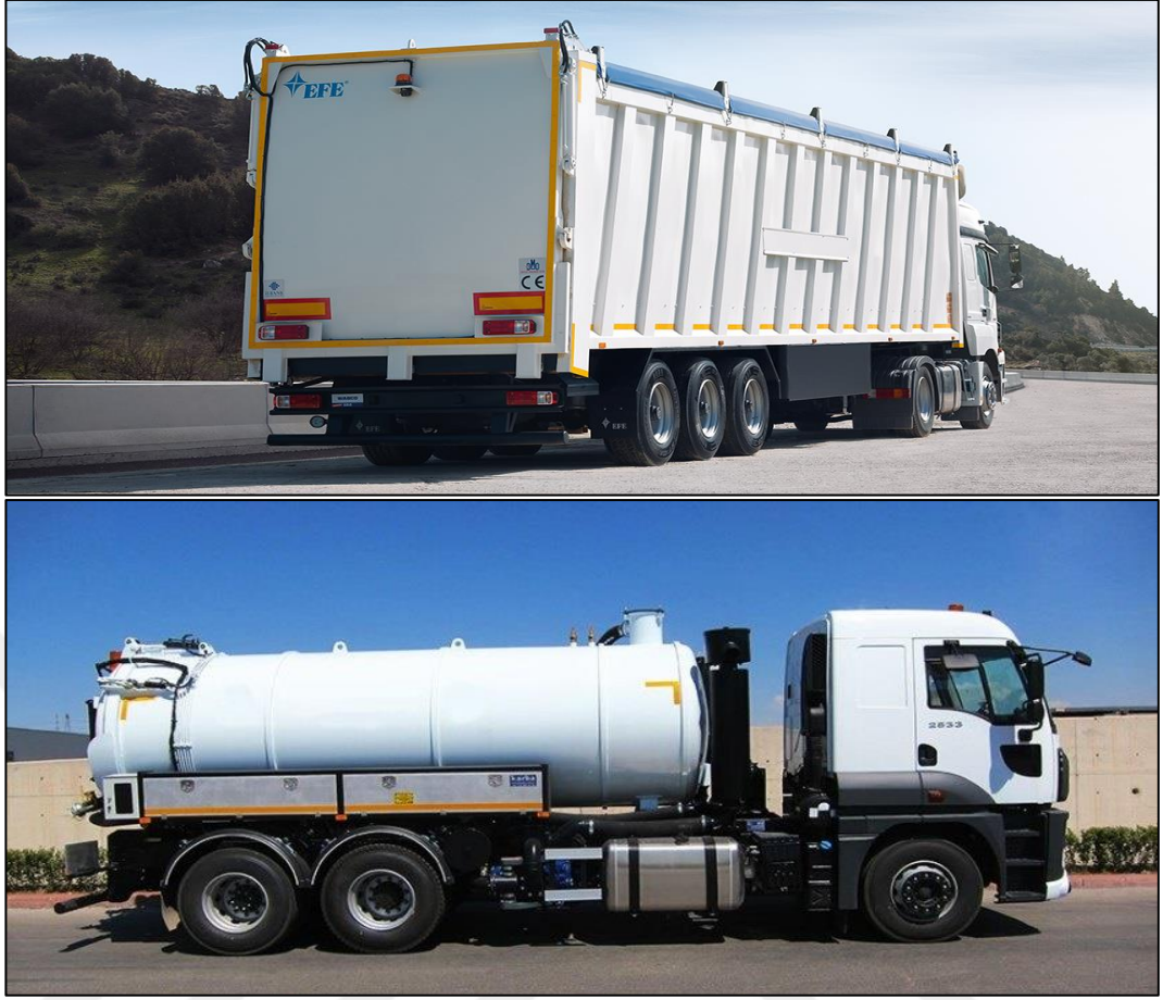
Şekil 3.7. Evsel atık aktarma işleminde kullanılan semitreyler ve sızıntı suyu aktarma işleminde kullanılan vidanjör
