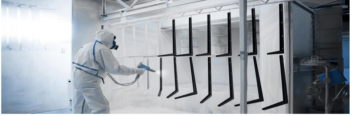
Şekil 5.6. Elektrostatik toz boyama prosesi
