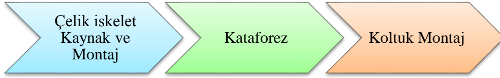
Şekil 5.1. Çelik iskeletli koltuk üretim akışı
