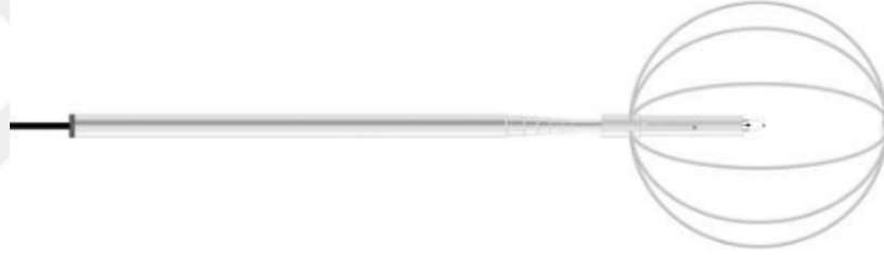
Şekil 3.7 Türbülans seviyesi probu (Seri No: 02998652)
