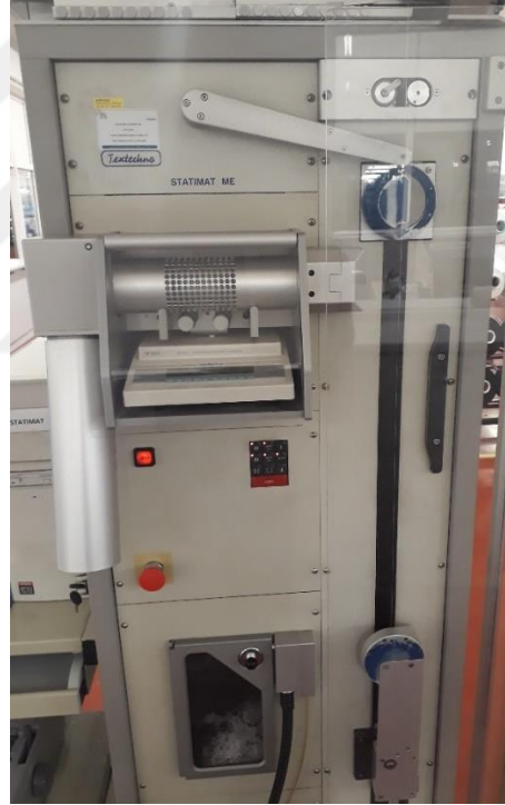
Őekil 3.7. Mukavemet ve uzama deęer tespiti iin kullanılan Statimat Me cihazı
