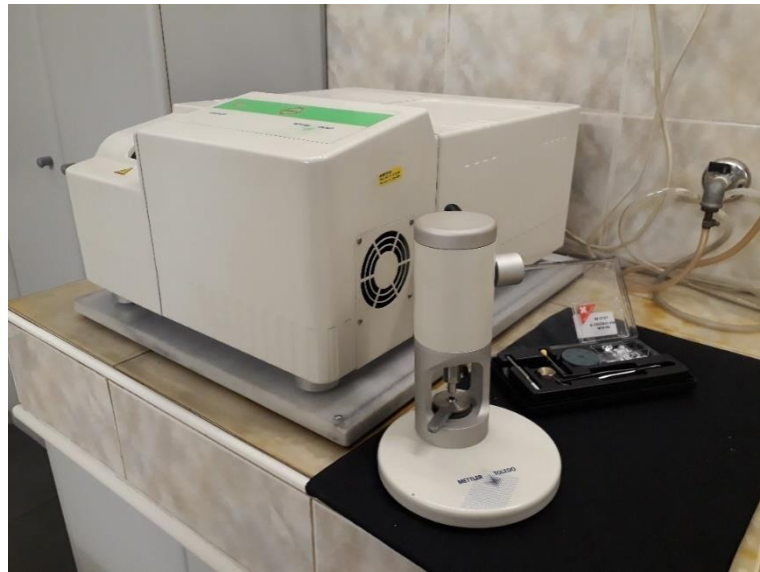
Şekil 3.8. Numunelerin ısıl testlerinde kullanılan DSC cihazı
