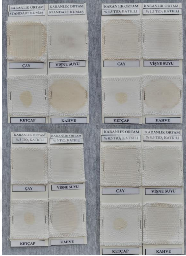
Şekil 4.7. Karanlık ortamda bulunan katkısız (%0 TiO 2 ), %1,5, %3 ve %4,5 TiO 2 katkılı kumaşlar
