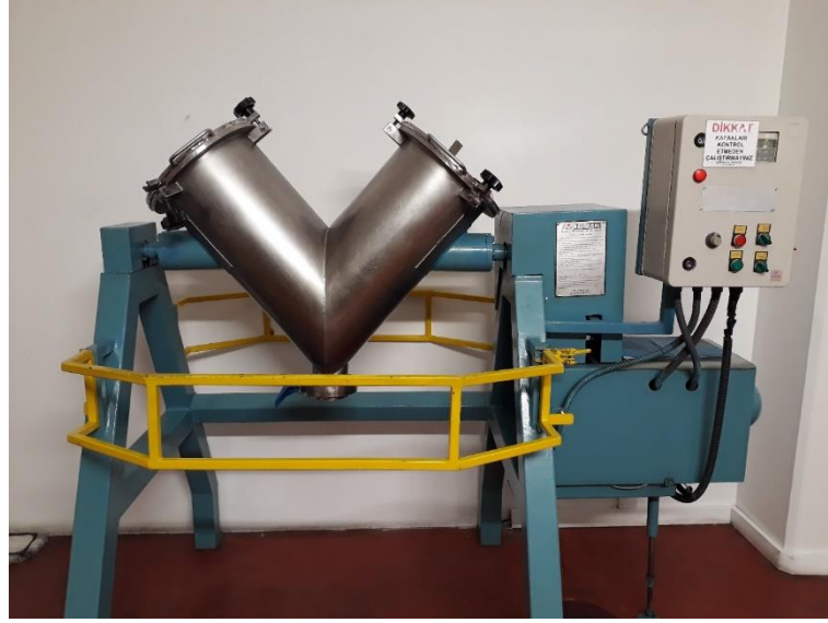
Şekil 3.3. V Tipi Mekanik Karıştırıcı
