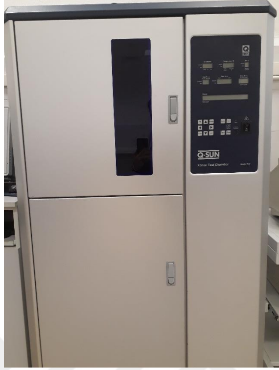
Şekil 3.5. Işık Haslığı Test Cihazı
