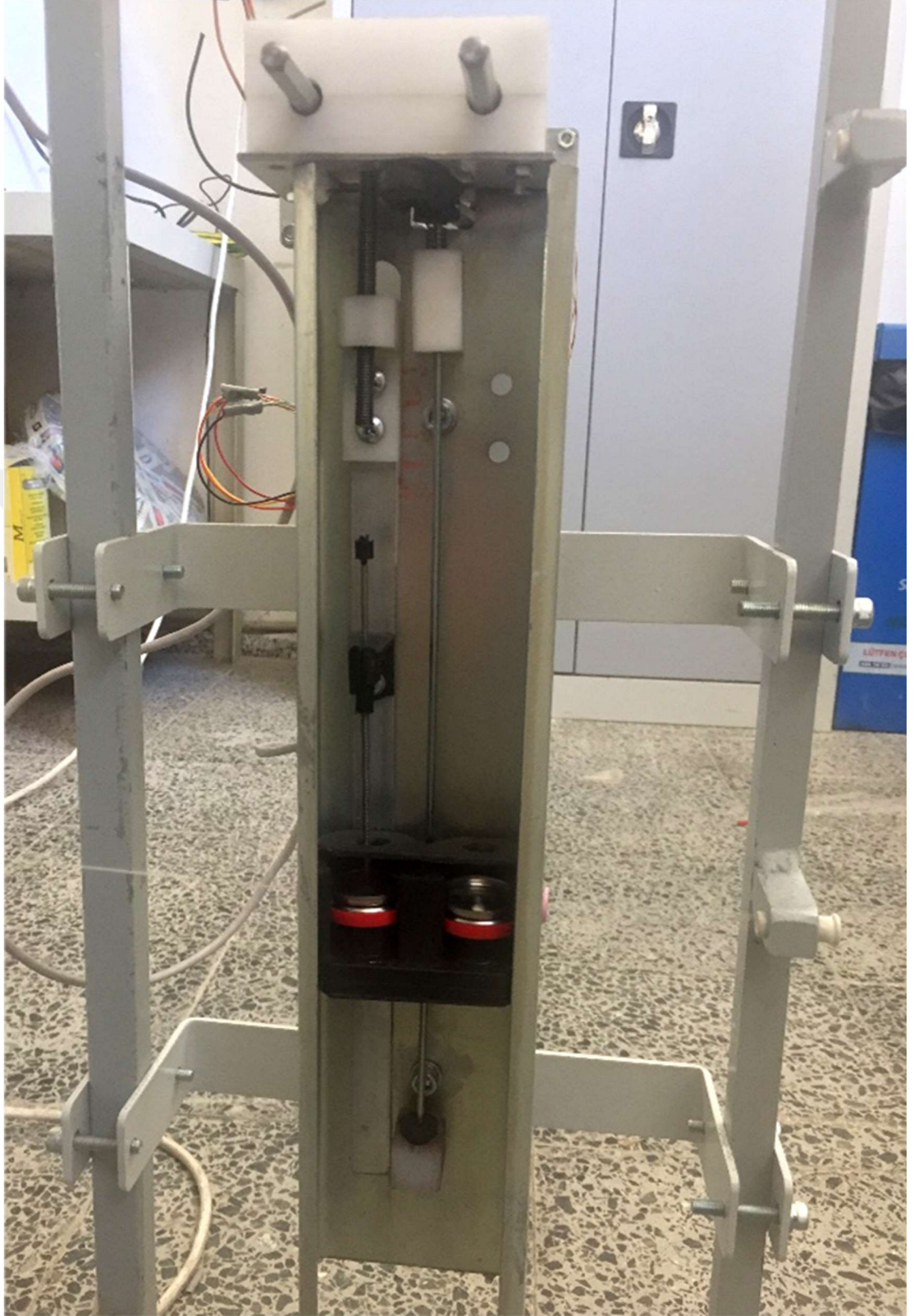
Şekil 3.10. Adım motoru kontrollü iplik fren sistemi
