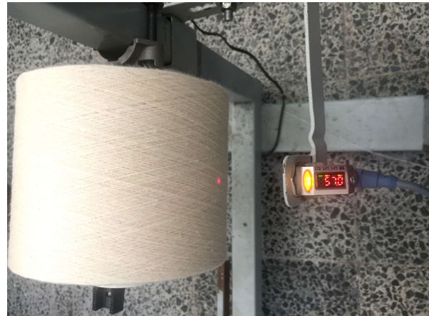
Şekil 3.5. Lazer sensör ile çap ölçümü
