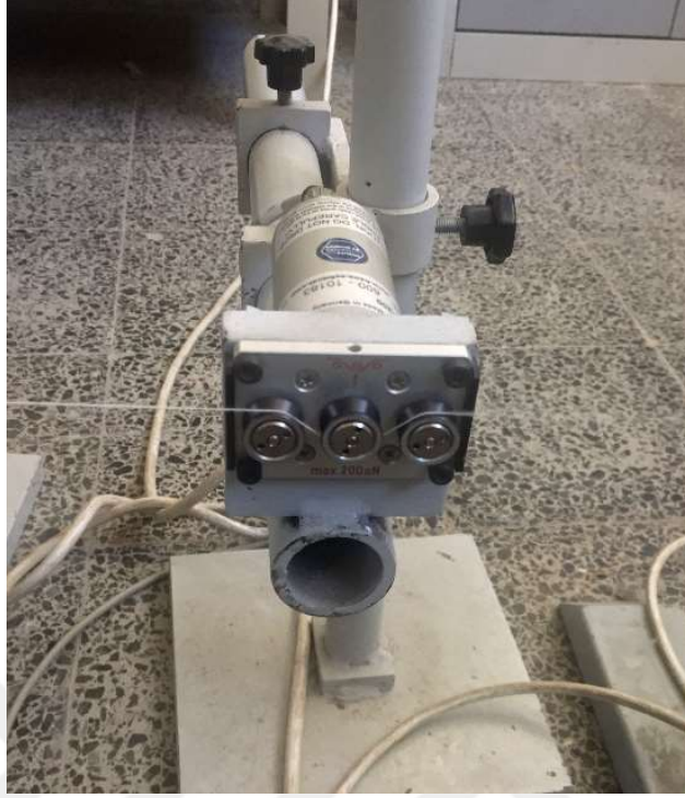
Şekil 3.7. Schmidt gerginlik ölçme sensörü
