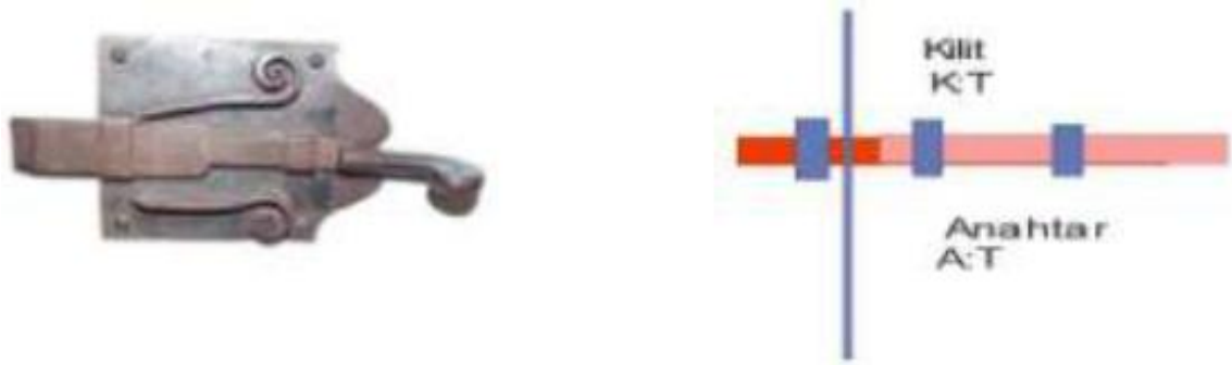
Şekil 3.56. Sürgülü kilit sistemi (Saraçoğlu ve Karakaş 2008).
