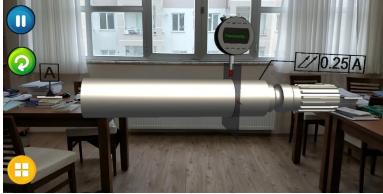
Şekil 4.28. Toplam salgı için farklı noktalardan ölçüm yapılması
