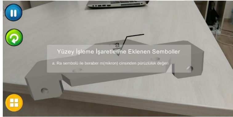
Şekil 4.23. Yüzey işleme işaretlerine eklenen sembollerin anlamları
