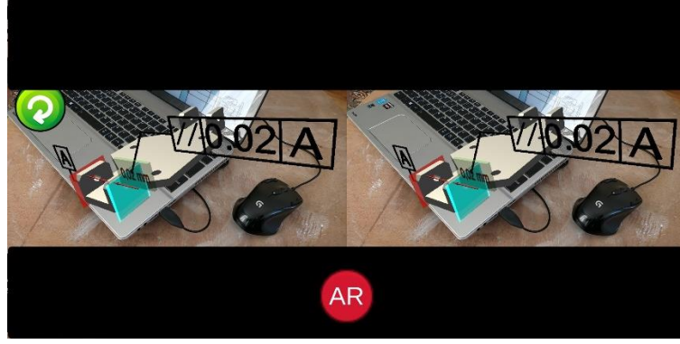
Şekil 4.47. Paralellik toleransının AG uygulamasında SG modunda incelenmesi
