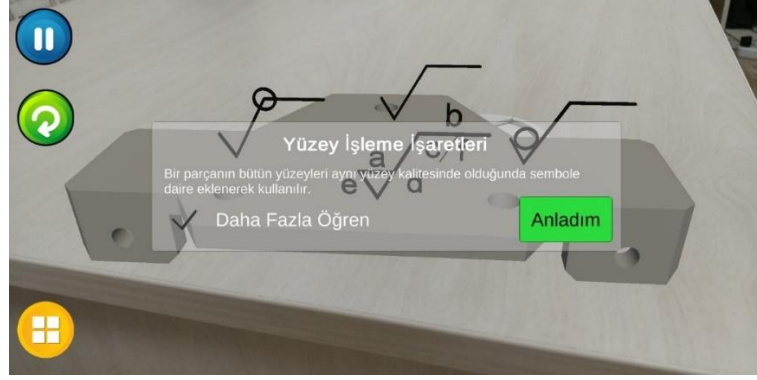
Şekil 4.24. Yüzey işleme işaretlerinin anlamları
