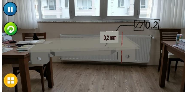
Şekil 4.32. Düzlemsellik toleransı animasyonu
