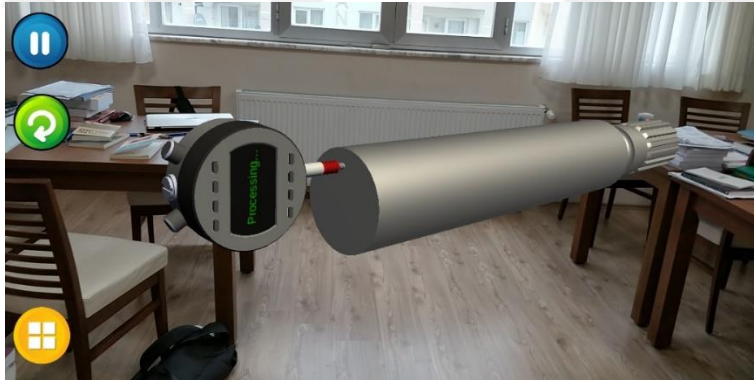
Şekil 4.30. Alın salgısının ölçülmesi
