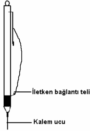
Şekil 2.9. Kalem grafit elektrot (Erdem ve ark. 2005).
