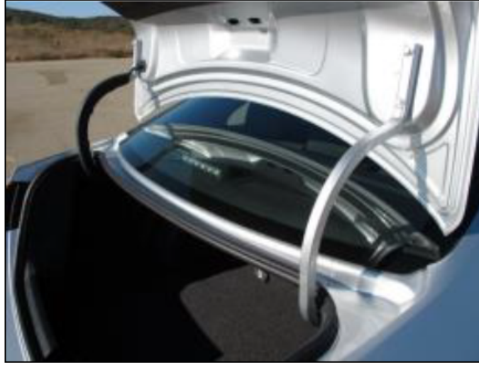
Şekil 2.5. Sedan araçlarda kullanılan kuğu boynu bagaj menteşesi (Özcan 2017'den alınmıştır)
