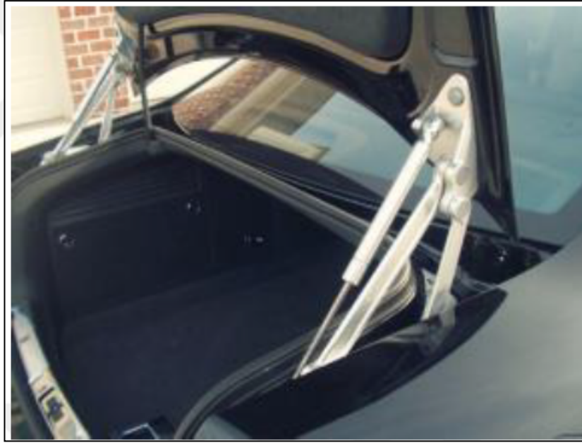
Şekil 2.6. Sedan araçlarda kullanılan dört kol bagaj kapağı menteşesi (Özcan 2017'den alınmıştır)
