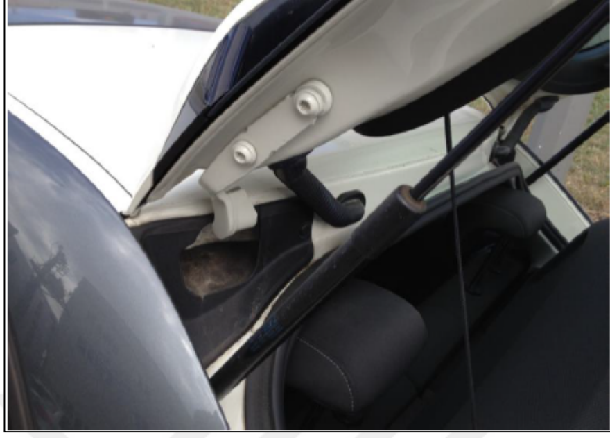
Şekil 2.4. Hatchback araçlarda kullanılan iki kollu bagaj kapağı menteşesi(Özcan 2017'den alınmıştır)
