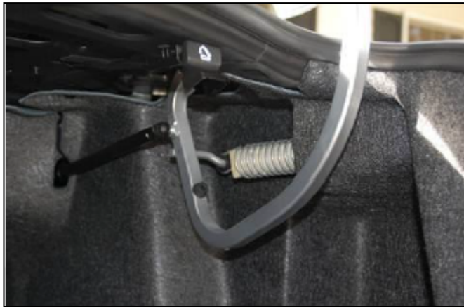
Şekil 2.10. Çekme yaylı ve gazlı yay takviyeli kuğu boynu bagaj kapağı menteşesi (Özcan 2017'den alınmıştır)
