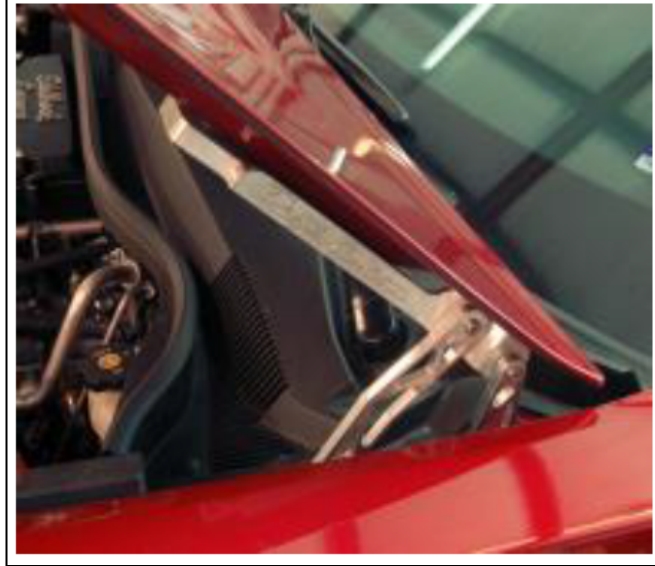
Şekil 2.3. Dört kol menkanizmalı ön kaput menteşesi (Özcan 2017'den alınmıştır)
