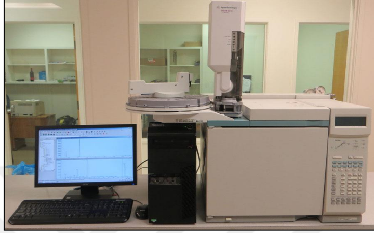
Şekil 3.9. Gaz kromatografi-elektron yakalama dedektörü (GC-ECD)
