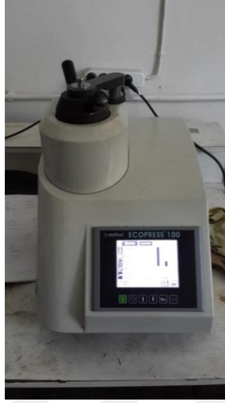
Şekil 3.6. Metkon Ecopress-100 marka bakalite alma cihazı
