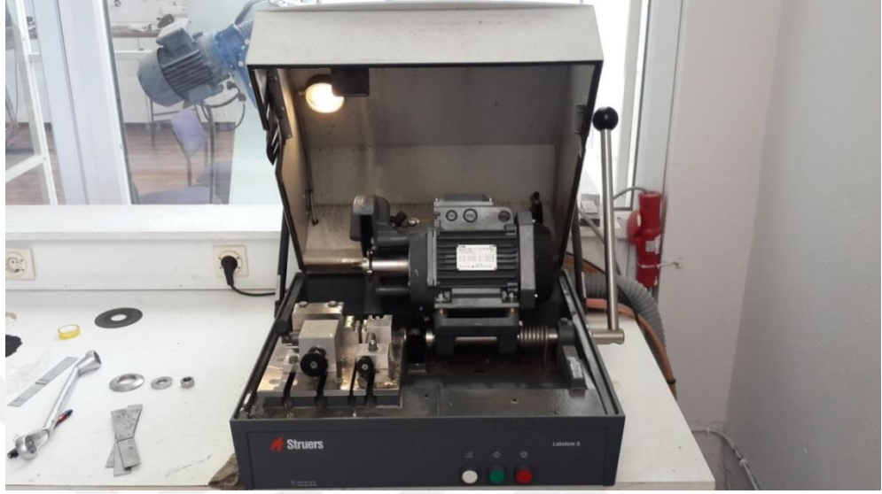
Şekil 3.5. Streurs marka abrasif kesme cihazı
