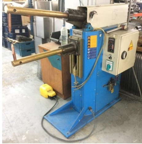
Şekil 3.3. Sağlam Makina Sanayi marka nokta direnç kaynağı makinesi
