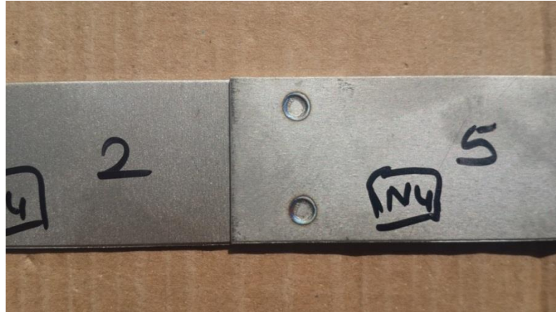
Şekil 3.4. Kaynak işlemi sonucunda elde edilen numune
