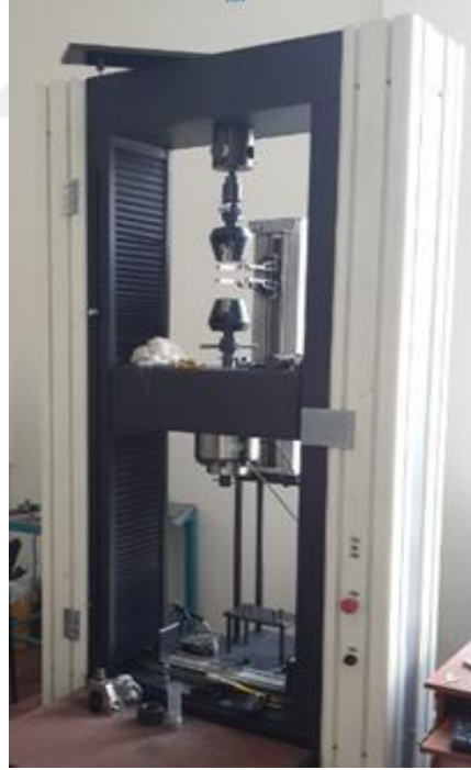
Şekil 3.9. Utest marka 25 tonluk universal çekme cihazı
