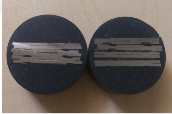
Şekil 3.8. Bakalite alınmış sertlik ölçüm numunesi
