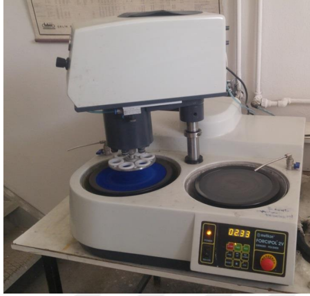
Şekil 3.7. Metkon-Forcimat marka otomatik parlatma cihazı
