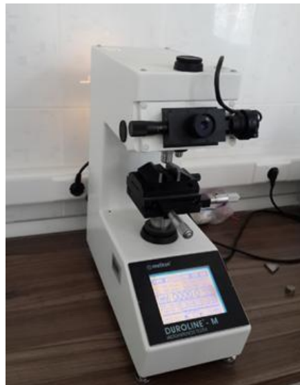
Şekil 3.12. Duroline-Metkon marka sertlik ölçüm cihazı
