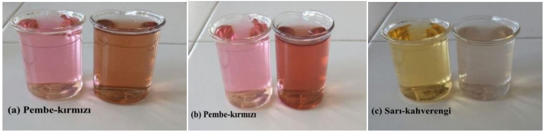
Şekil 4.5. Ön mordonlama yöntemi ile ipek ağırlığının %1'i potasyum sodyum tartarat mordan maddesi kullanılarak yapılan boyama sonrasında karşılaştırma çözeltisi ile ekstrakt çözeltisinin karşılaştırması; (a) pH 4,0, (b) pH 5,0, (c) pH 6,0
