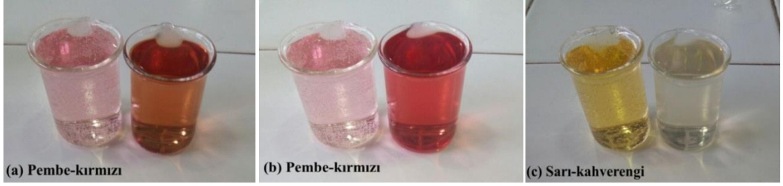
Şekil 4.12. Birlikte mordonlama yöntemi ile ipek ağırlığının %2'si potasyum sodyum tartarat mordan maddesi kullanılarak yapılan boyama sonrasında karşılaştırma çözeltisi ile ekstrakt çözeltisinin karşılaştırması; (a) pH 4,0, (b) pH 5,0, (c) pH 6,0
