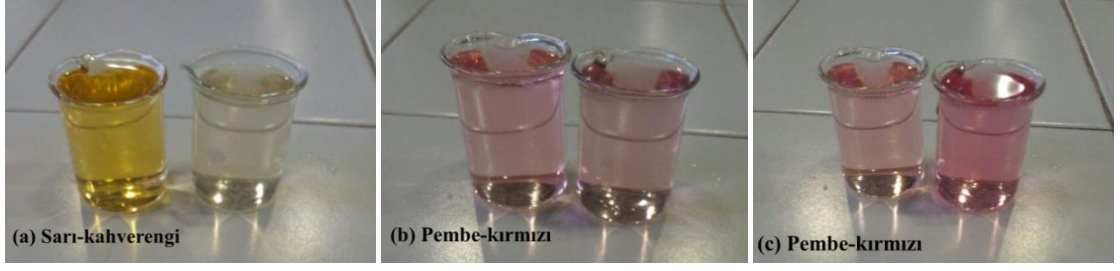
Şekil 4.9. Birlikte mordonlama yöntemi ile ipek ağırlığının %2'si demir-II sülfat mordan maddesi kullanılarak yapılan boyama sonrasında karşılaştırma çözeltisi ile ekstrakt çözeltisinin karşılaştırması; (a) pH4,0, (b) pH 5,0, (c) pH 6,0
