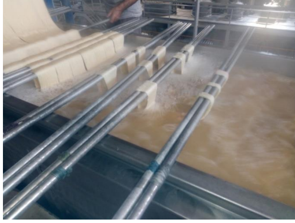
Şekil 3.17. Serisin banyosunda işlem gören ipek çileleri
