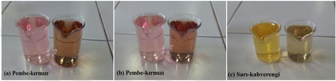
Şekil 4.10. Birlikte mordonlama yöntemi ile ipek ağırlığının %0,5'i potasyum sodyum tartarat mordan maddesi kullanılarak yapılan boyama sonrasında karşılaştırma çözeltisi ile ekstrakt çözeltisinin karşılaştırması; (a) pH 4,0, (b) pH 5,0, (c) pH 6,0
