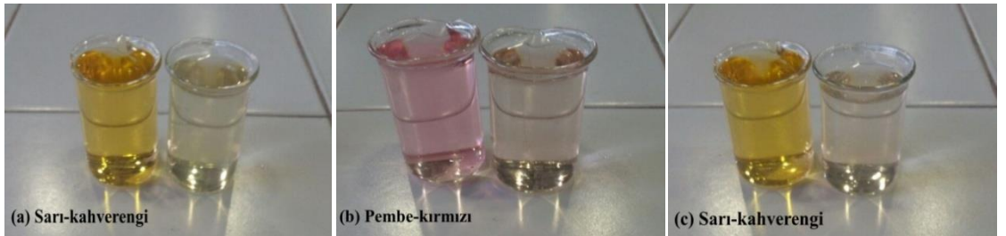
Şekil 4.8. Birlikte mordonlama yöntemi ile ipek ağırlığının %1'i demir-II sülfat mordan maddesi kullanılarak yapılan boyama sonrasında karşılaştırma çözeltisi ile ekstrakt çözeltisinin karşılaştırması; (a) pH 4,0, (b) pH 5,0, (c) pH 6,0
