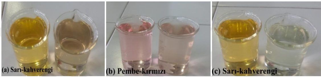
Şekil 4.13. Son mordonlama yöntemi ile ipek ağırlığının %0,5'i demir-II sülfat mordan maddesi kullanılarak yapılan boyama sonrasında karşılaştırma çözeltisi ile ekstrakt çözeltisinin karşılaştırması; (a) pH 4,0, (b) pH 5,0, (c) pH 6,0
