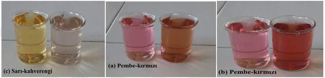
Şekil 4.4. Ön mordonlama yöntemi ile ipek ağırlığının %0,5'i potasyum sodyum tartarat mordan maddesi kullanılarak yapılan boyama sonrasındakarşılaştırma çözeltisi ile ekstrakt çözeltisinin karşılaştırması; (a) pH 4,0, (b) pH 5,0, (c) pH 6,0
