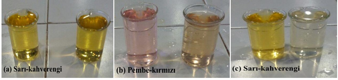
Şekil 4.18. Son mordonlama yöntemi ile ipek ağırlığının %2'si potasyum sodyum tartarat mordan maddesi kullanılarak yapılan boyama sonrasında karşılaştırma çözeltisi ile ekstrakt çözeltisinin karşılaştırması; (a) pH 4,0, (b) pH 5,0, (c) pH 6,0
