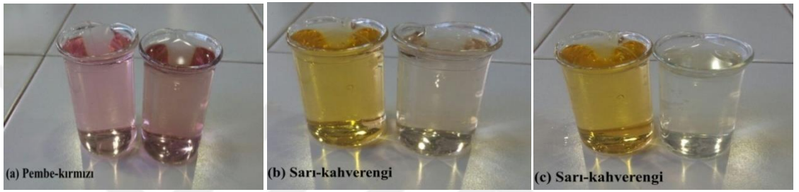
Şekil 4.7. Birlikte mordonlama yöntemi ile ipek ağırlığının %0,5'i demir-II sülfat mordan maddesi kullanılarak yapılan boyama sonrasında karşılaştırma çözeltisi ile ekstrakt çözeltisinin karşılaştırması; (a) pH 4,0, (b) pH 5,0, (c) pH 6,0
