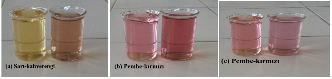
Şekil 4.6. Ön mordonlama yöntemi ile ipek ağırlığının %2'si potasyum sodyum tartarat mordan maddesi kullanılarak yapılan boyama sonrasında karşılaştırma çözeltisi ile ekstrakt çözeltisinin karşılaştırması; (a) pH 4,0, (b) pH 5,0, (c) pH 6,0
