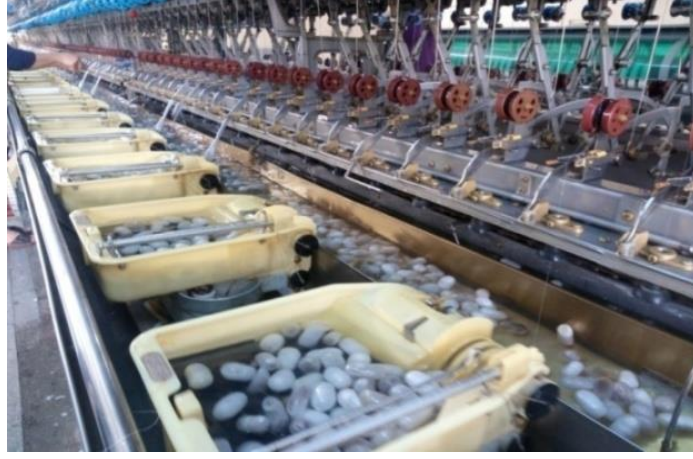
Şekil 3.13. Arabalarda bulunan kozaların aktarımı
