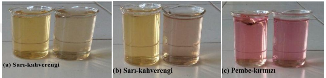
Şekil 4.1. Ön mordondlama yöntemi ile ipek ağırlığının %0,5'i demir-II sülfat mordan maddesi kullanılarak yapılan boyama sonrasında karşılaştırma çözeltisi ile ekstrakt çözeltisinin karşılaştırması; (a) pH 4,0, (b) pH 5,0, (c) pH 6,0
