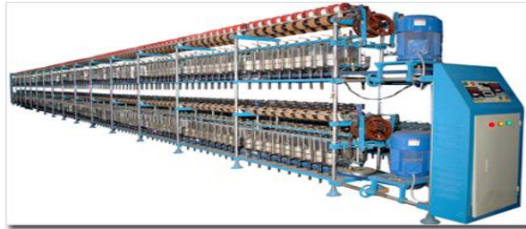
Şekil 2.7. Katlama ve büküm makinesi ( http://www.shivamengg.com/tfo-twister-pure-silk.html )
