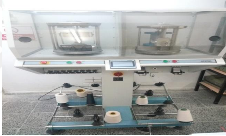
Şekil 3.16. Ham ipek ipliklerini katlanması ve bükülmesi
