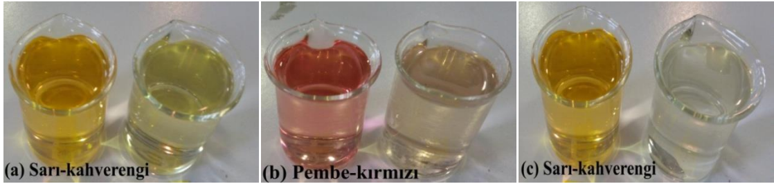
Şekil 4.14. Son mordonlama yöntemi ile ipek ağırlığının %1'i demir-II sülfat mordan maddesi kullanılarak yapılan boyama sonrasında karşılaştırma çözeltisi ile ekstrakt çözeltisinin karşılaştırması; (a) pH 4,0, (b) pH 5,0, (c) pH 6,0
