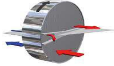
Şekil 2.5. Isı tekerleğinde zıt akış (Anonim 2015)
