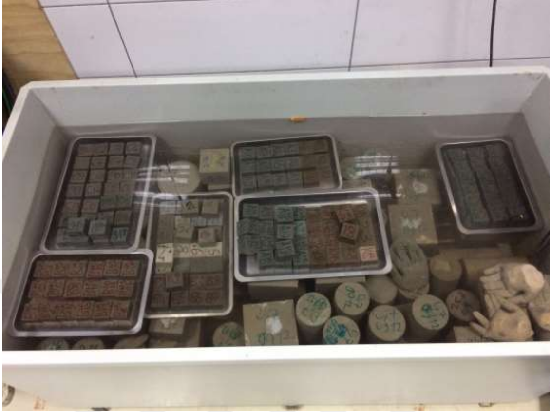
Şekil 3.2. Numunelerin kür havuzundaki görüntüleri
