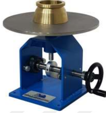
Şekil 3.4. Yayılma tablası ve kesik koni şekilli kalıp
