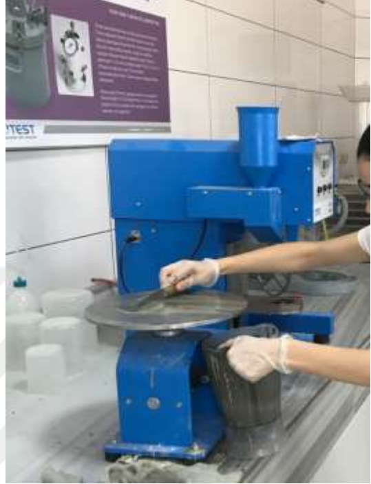
Şekil 3.3. Marsh-hunisi ve mini-yayılma deneylerinde kullanılan aletler
