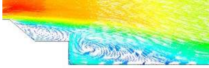
Şekil 4.3. Taşıt modeli 1'in arka bölümündeki akış hareketleri
