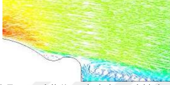
Şekil 4.17. Taşıt modeli 4'ün arka bölümündeki akış hareketleri
