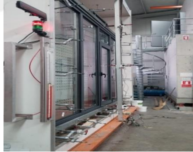
Şekil 2.9. Rüzgâr dayanım testi doğrama uygulaması (Kişisel arşiv 2019).
