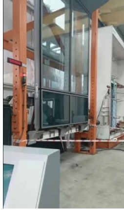
Şekil 2.10. Sehim testi laboratuvar uygulaması (Kişisel arşiv 2019).
