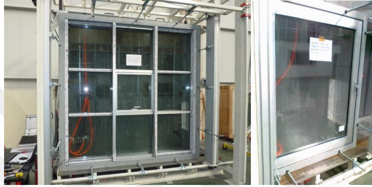
Şekil 2.7. Giydirme cephe su geçirimsizlik testi (Kişisel arşiv 2019).
