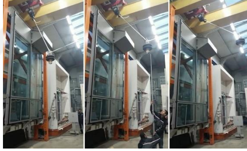
Şekil 2.11. Temperli cama farklı yükseklikten bırakılan sarkaç testi (Kişisel arşiv 2019).
