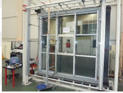
Şekil 2.6. Giydirme cephe hava geçirgenlik testi (Kişisel arşiv 2019).
