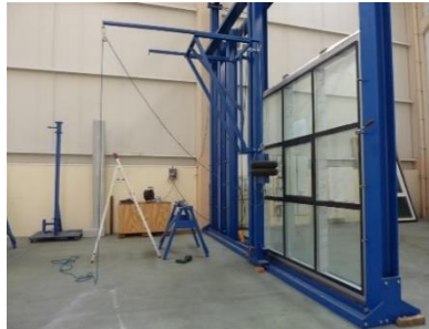
Şekil 2.12. Lamine cama darbe dayanımı uygulama testi (Kişisel arşiv 2019).
