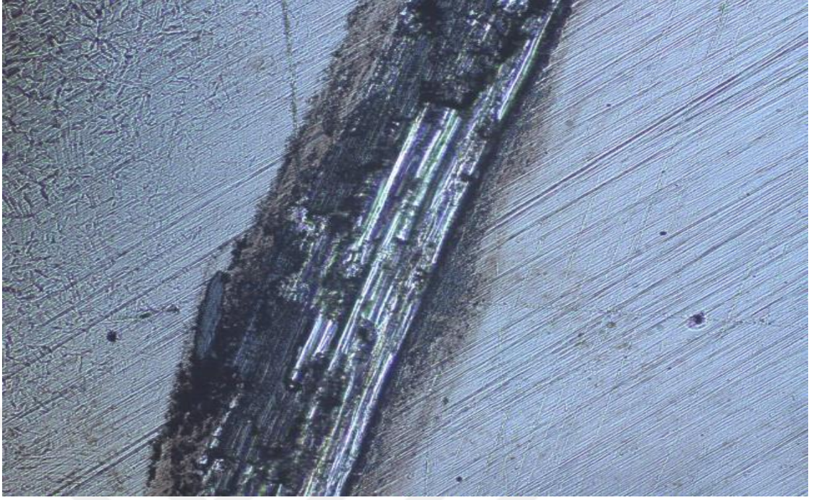
Şekil 4. 20. PN450 kodlu numunenin 0.7 kg yükte 5 mm/s kayma hızında oluşan aşınma optik mikroskop görüntüsü X100
