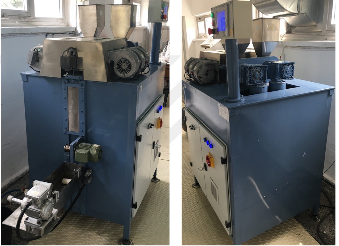
Şekil 3.1. Eriyikten çekim pilot üretim makinesinin ekstrüderler, çekim motoru, sarım motoru, düze paketi, kontrol paneli, soğutma ünitesi ve cips yükleme silolarıyla birlikte genel görünümü
