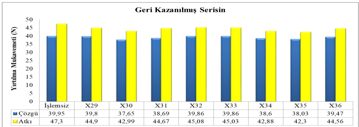
Şekil 4.25. Ham pamuk ve geri kazanılmış serisin uygulanmış pamuklu kumaşların atkı ve çözgü yönündeki yırtılma mukavemeti değerleri
