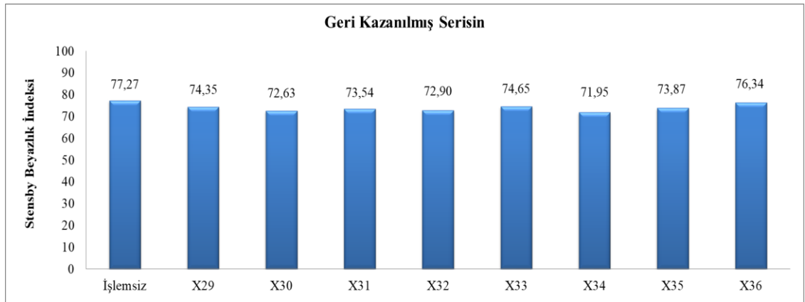
Şekil 4.45. Ham pamuk ve geri kazanılmış serisin uygulanmış kumaşların Stensby beyazlık indeksi değerleri
