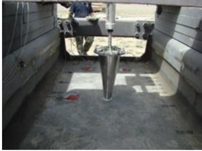
Şekil 3.22. Deformasyon konisi (Kurtoğlu 2015)
