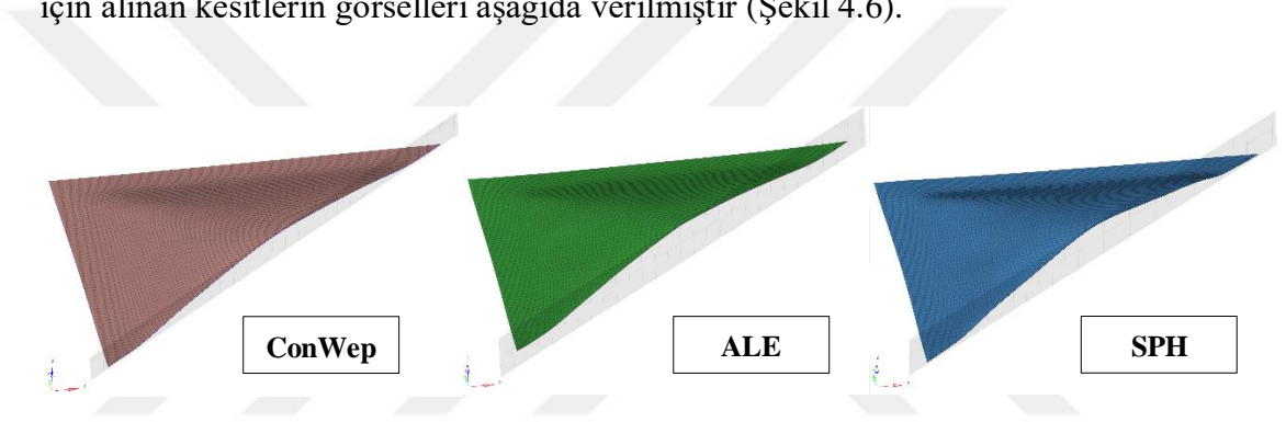
Şekil 4.6. Kalıcı deformasyona sahip test numunelerinin köşegen üzerinde alınan kesit görselleri
