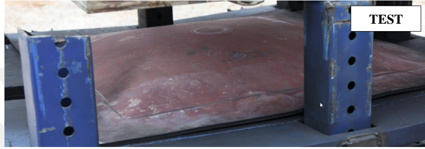
Şekil 4.10. Analiz çalışmaları sonucunda kalıcı deformasyonlar - görsel 1
