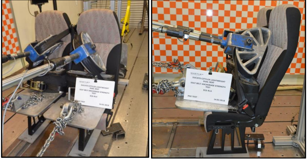
Şekil 4.14. ECE R14 Emniyet kemer çekme testi üst ve alt blok gösterimi
