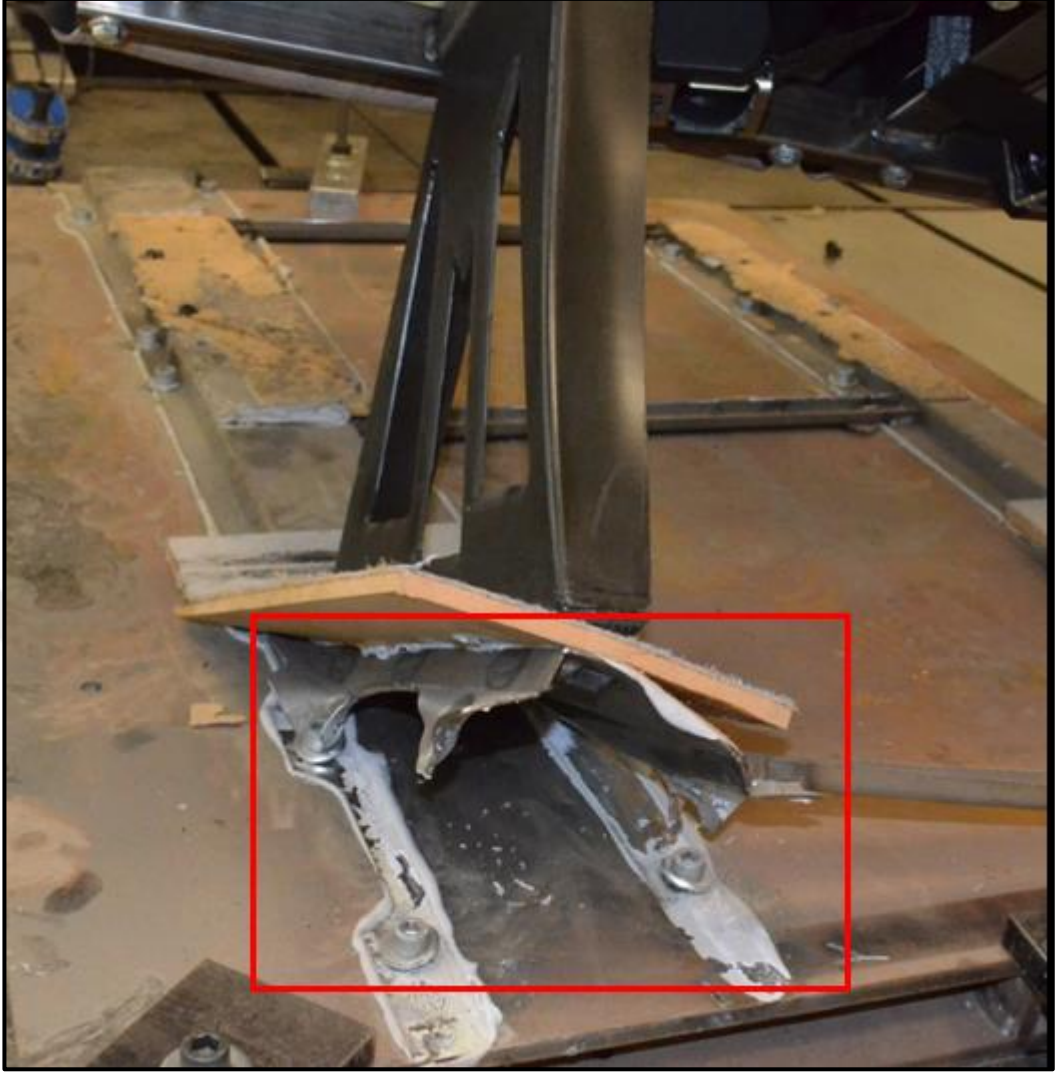
Şekil 4.18. Testte ayak bağlantılarında meydana gelen olumsuzlukların görünümü
