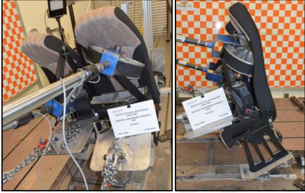
Şekil 4.16. ECE R14 Emniyet kemer testi sonrası görünüm
