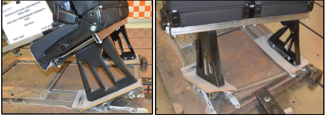
Şekil 4.17. ECE R14 Emniyet kemer testinin sonrası ayak bağlantılarının test sonrası görünümü
