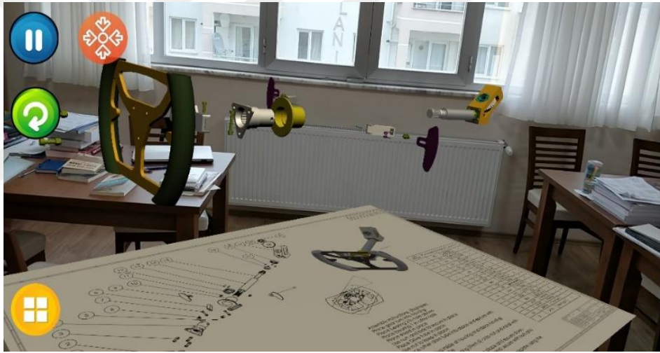
Şekil 3.6. Montaj konusuna ait AG uygulaması mobil ekran görüntüsü
