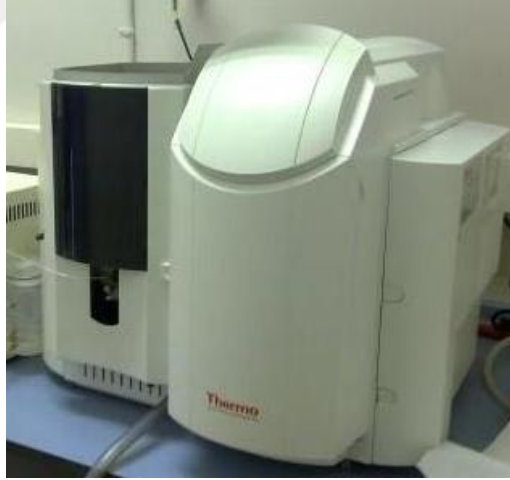
Şekil 3.1. Atomik Absorpsiyon Spektrometre (AAS) cihazı
