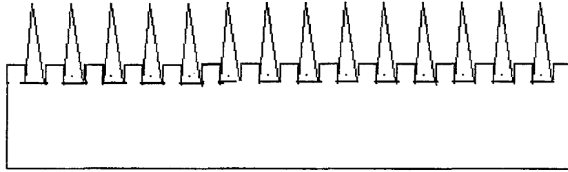
Şekil.1. Garnet telleriyle kaplanmış davulun büyütülmüş kesiti.
