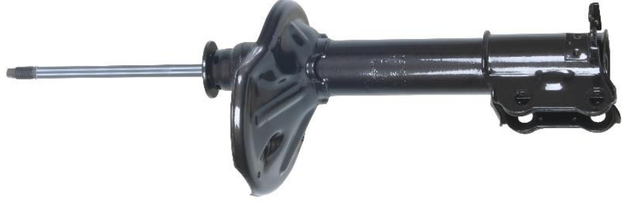
Şekil 2.14. MacPherson tip süspansiyonlarda kullanılan amortisör (Strat) ve alt braket bağlantısı
