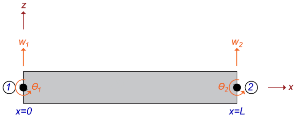
Şekil 3.5. Eğilme elemanı için deplasman parametrelerinin gösterimi
