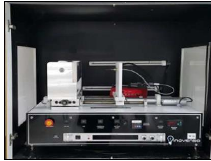
Şekil 3.9. Nanolifli yüzeylerin üretildiği elektro çekim ünitesi
