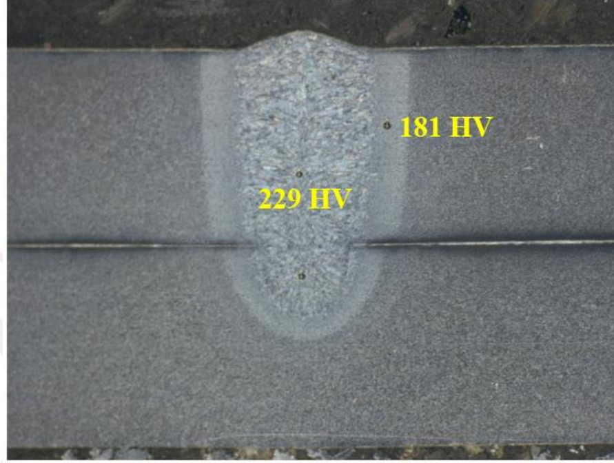
Şekil 4.25. Laser nokta kaynağı numunesinden sertlik ölçümü alınan noktalar
