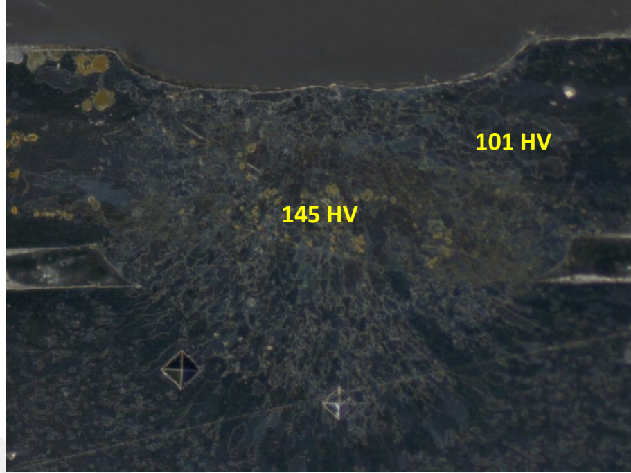
Şekil 4.29. 4 nolu numuneden sertlik ölçümü alınan noktalar
