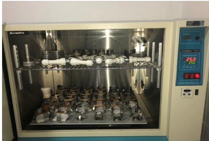
Şekil 3.15. Y-Olfaktometrelerin bekletildiği 25 °C'ye ayarlı etüv
