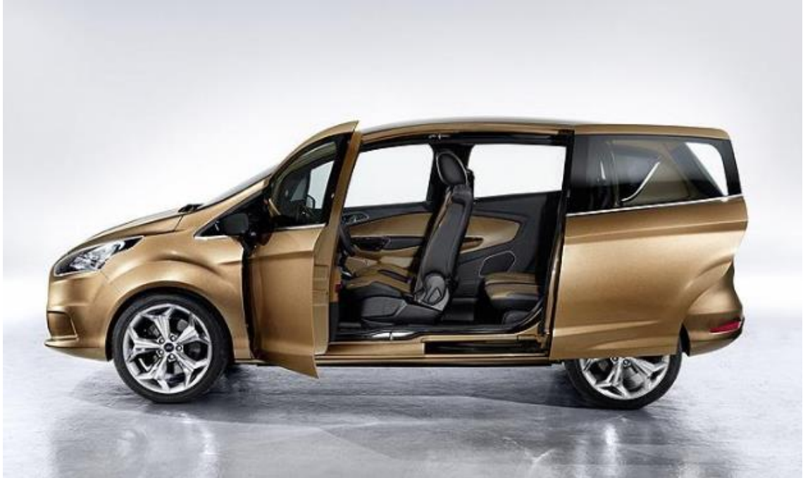
Şekil 3.2. Kayar kapı sistemi (Kranz 2019)
