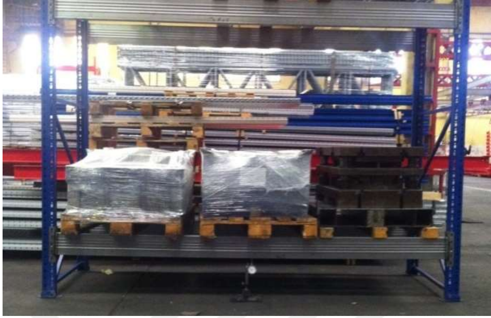
Şekil 4.22. Çeşitli yükler altında deformasyonu elde etmek için hazırlanan yatay taşıyıcı sehim testi düzeneği
