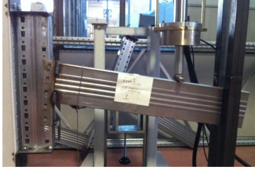
Şekil 4.6. Alt-üst U kaynaklı yatay taşıyıcının konsol testi sonrası görünümü
