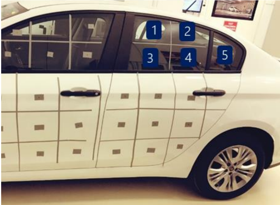
Şekil 4.18. Arka sol kapı camı paneli ve panelcikleri
