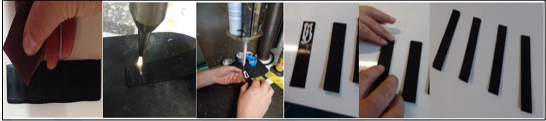
Şekil 3.11. Yapılan işlemler (Atmosferik plazma+Zımpara yüzey işlem uygulanmış)
