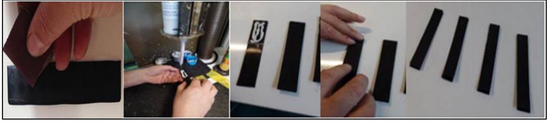
Şekil 3.10. Yapılan işlemler (Zımpara yüzey işlem uygulanmış)
