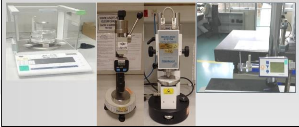
Şekil 3.13. Kullanılan ölçüm aletleri (Soldan: Yoğunluk, ShA, IRHD ve Yüzey Pürüzlülük)
