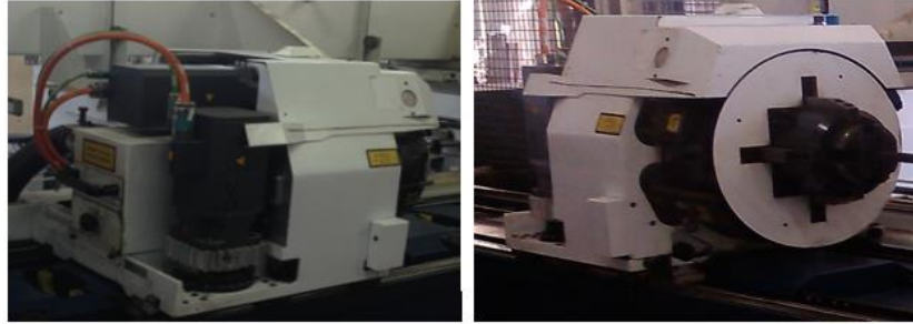
Şekil 3.8. TRUMPF Firmasının Boru-Profil Lazer Kesim Pnömatik Ayna Örnekleri (Anonim 2016)
