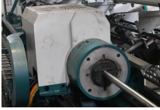
Şekil 3.9. BLM Firması Boru-Profil Lazer Kesim Hidrolik Ayna (Anonim 2016)
