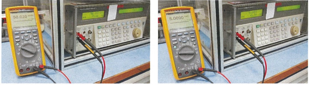
Şekil 4.13. Multimetre AC voltaj kalibrasyonu
