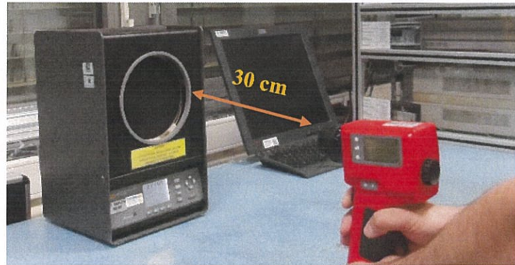
Şekil 4.4. Infrared termometre kalibrasyonu
