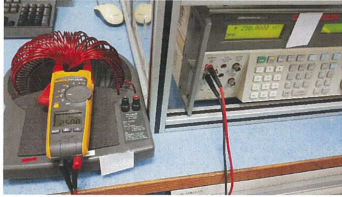
Şekil 4.26. Pens ampermetre DC voltaj kalibrasyonu
