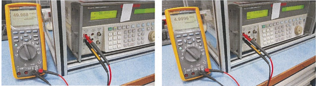
Şekil 4.14. Multimetre DC voltaj kalibrasyonu
