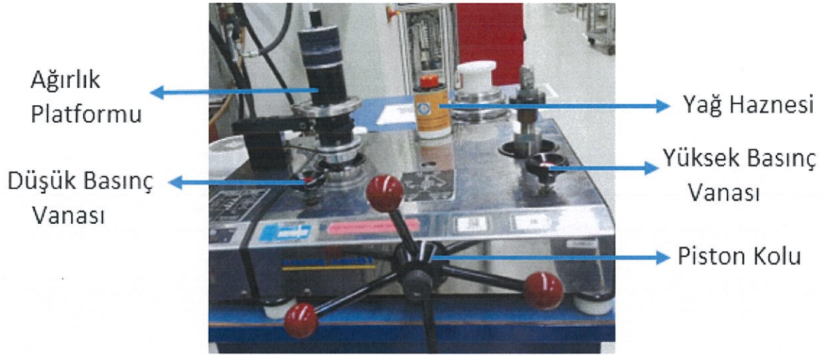
Şekil 4.5. Ölü ağırlık test cihazı
