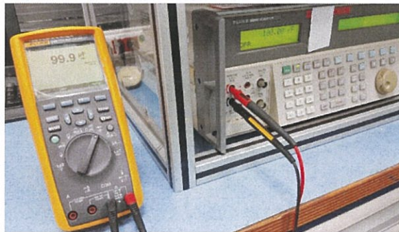
Şekil 4.16. Multimetre kapasite kalibrasyonu
