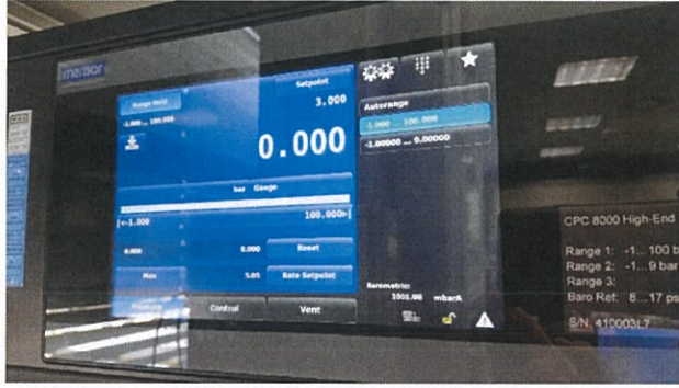
Şekil 4.8. CPC8000 cihaz ekranı ölçüm aralığı seçimi
