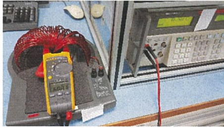
Şekil 4.27. Pens ampermetre direnç ve kapasite kalibrasyonu
