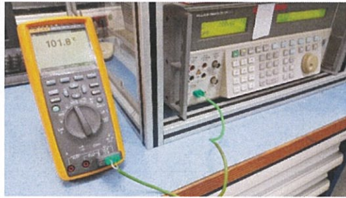
Şekil 4.18. Multimetre sıcaklık kalibrasyon
