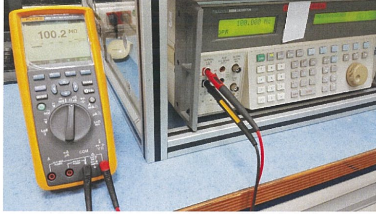
Şekil 4.15. Multimetre direnç kalibrasyonu
