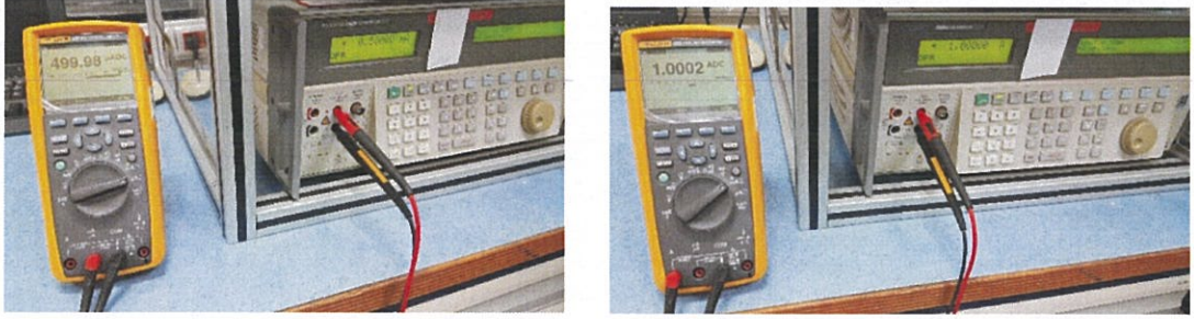
Şekil 4.19. Multimetre akım kalibrasyonu
