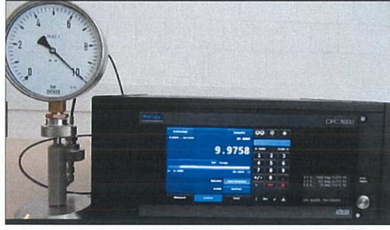
Şekil 4.10. Manometre-Referans cihaz bağlantısı Örneği
