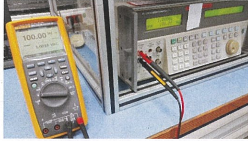
Şekil 4.17. Multimetre frekans kalibrasyonu
