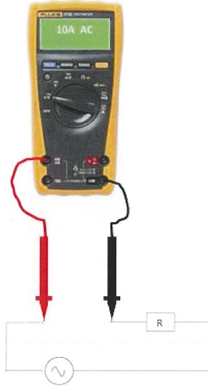
Şekil 3.14. Akım ölçümünde multimetre prob uç bağlantısı (Anonim 2015b)
