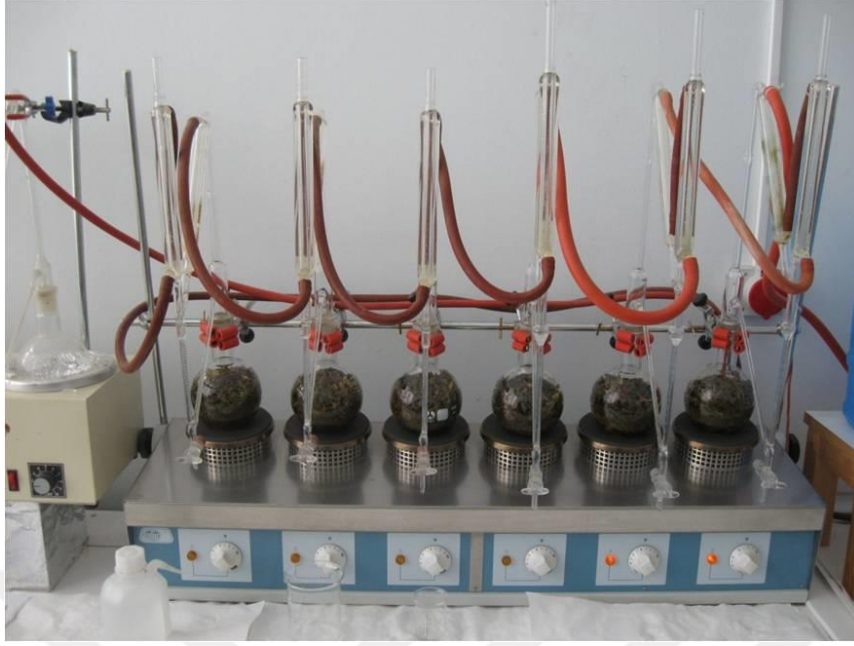
Şekil 3.22 Neo-Clevenger aperiyi ile uçucu yağ eldesi
