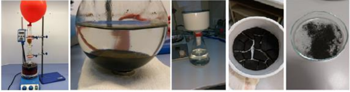
Şekil 3.2. Fe 3 O 4 nanopartiküllerinin sentez aşamaları
