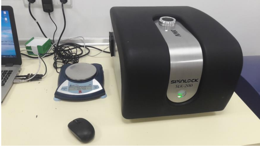
Şekil 3.15. Yağ analizi ölçümünde kullanılan NMR (Nükleer Manyetik Rezonans) cihazına ait görünüm
