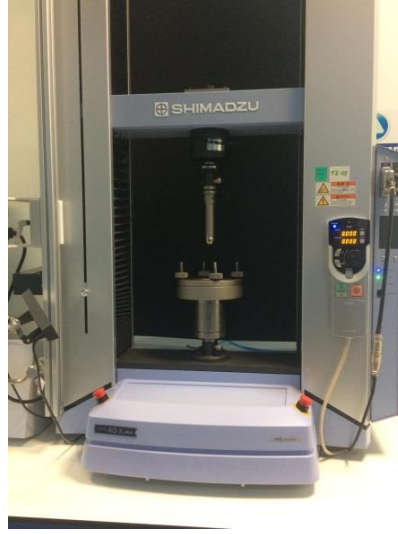
Şekil 3.4 Patlama mukavemetlerinin gerçekleştirildiği Shimadzu AG-X HS marka test cihazı
