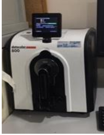
Şekil 3.3 Renk ölçümlerinin gerçekleştirildiği Datacolor 800 marka spektrofotometre
