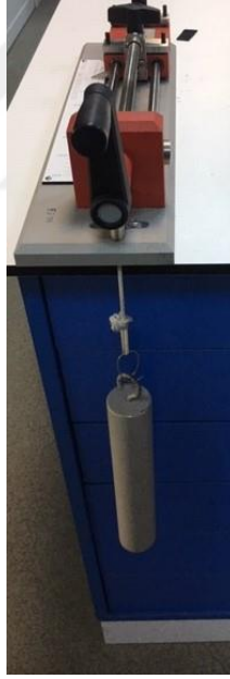
Şekil 3.7 Uzama testlerinin yapıldığı Fryma marka kumaş ekstansiyometresi
