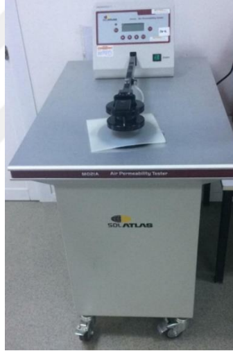
Şekil 3.5 Hava geçirgenliği ölçümlerinin yapıldığı SDL ATLAS M021A marka test cihazı
