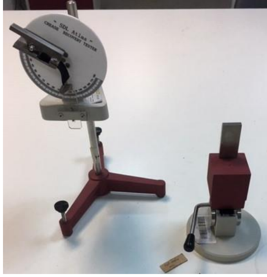
Şekil 3.8 Kat düzleme açısı ölçümlerinin yapıldığı SDL ATLAS M003B marka ölçüm cihazı
