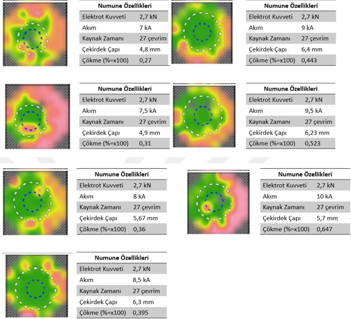
Şekil 4.2. Kaynak akımı değişimine göre ultrason kontrol örnekleri
