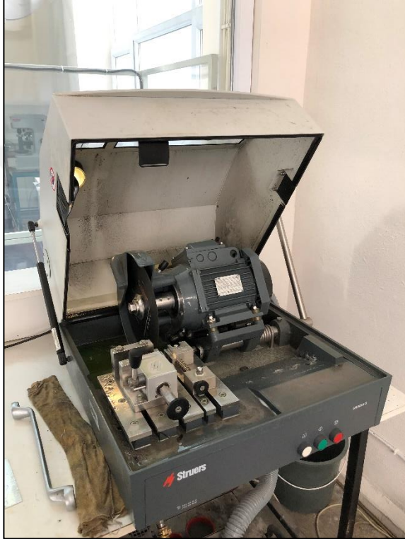
Şekil 3.7. Kullanılan numune kesme cihazı ve çekirdek bölgelerinden kesit alınan numuneler
