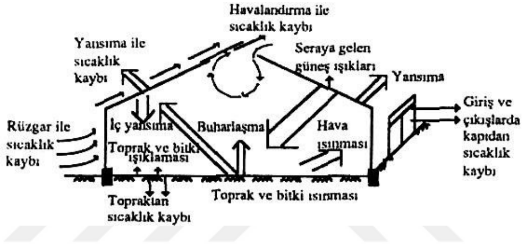
Şekil 2.6. Güneş ışınlarının sera içine girişi (Yüksel 2004).
