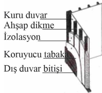
Şekil 2.35. Panel bağlantıları ve katmanları (Çakır 2000)
