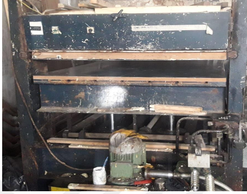
Şekil 3.5. Dolap yan panellerinin içine poliüretan basılan kalıp
