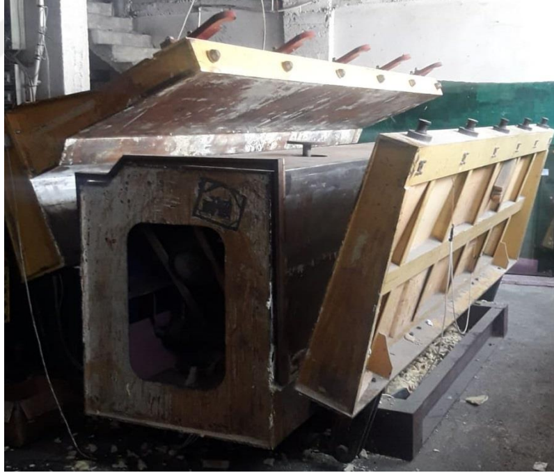
Şekil 3.6. Dolap karkasına poliüretan basılan kalıp
