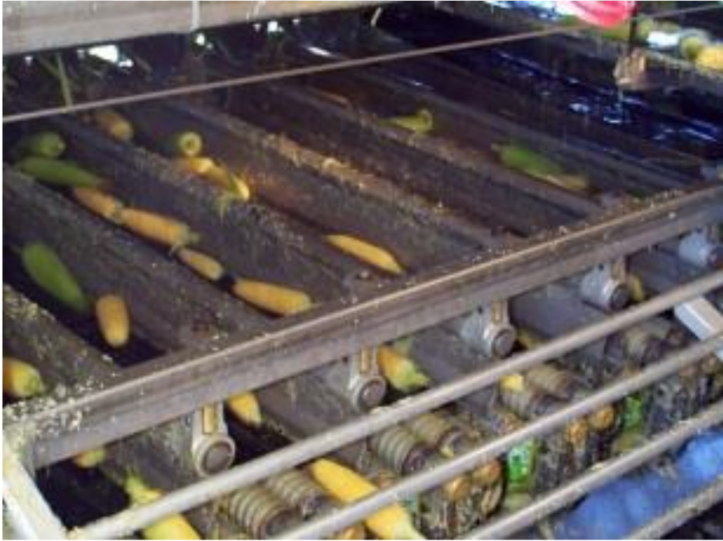
Şekil 2.2. Hasat edilen tatlı mısırların kavuzlarının soyulma işlemi
