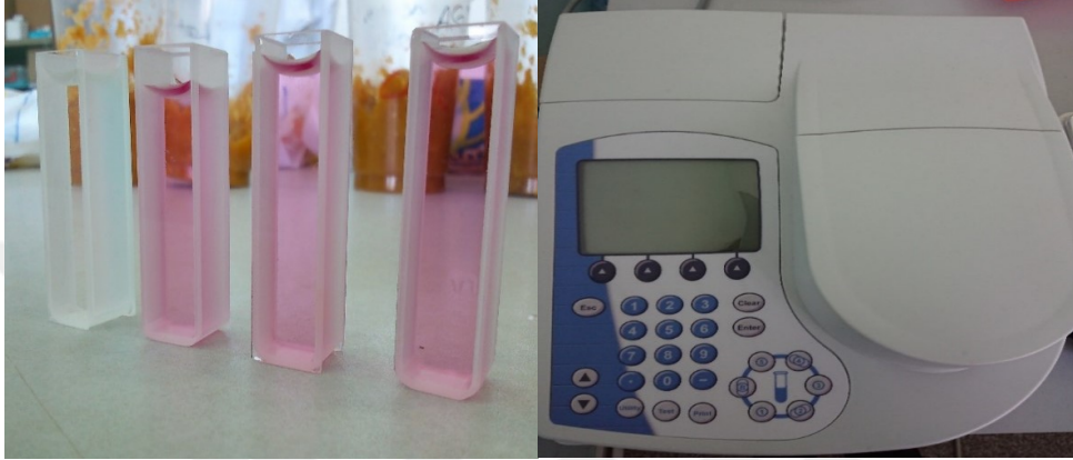
Şekil 3.12. Askorbik asit analizi için hazırlanan örnekler ve Thermo Scientific GENESYS 10S UV-Vis marka spektrofotometre.
