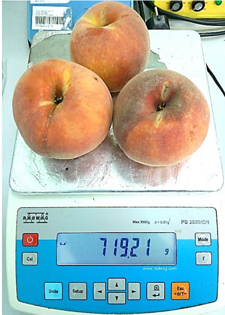
Şekil 3.8. Radwag PS 3500/C/1 marka terazi ile ağırlık ölçümü.
